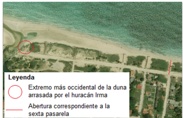
Figura 11. Ubicación de las zonas puntuales en la playa Boca Ciega donde se produjo la invasión de arena hacia tierra durante el paso del huracán Irma
