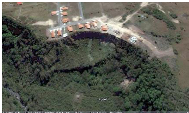
Figura 2. Serie de deslizamientos de tierra muy próximos a un desarrollo inmobiliario en las proximidades de la Quebrada Emporio, Panamá. Nótese el reescalamiento sucesivo de los deslizamientos.
