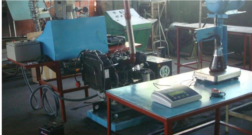
Figura 1. Foto del grupo electrógeno de prueba Lister Petter LPWS2 utilizado.
