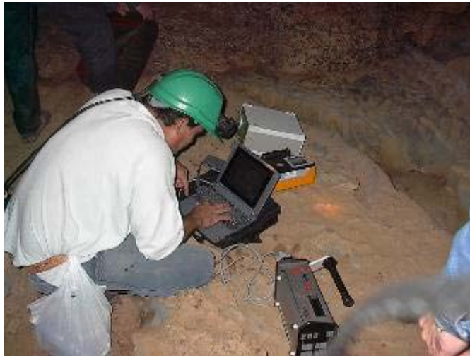
Fig. 34. Mediciones de Radón 222 en el aire y las rocas de una de las galerías de la Gran Caverna de Santo Tomás, Pinar del Río, Cuba.
