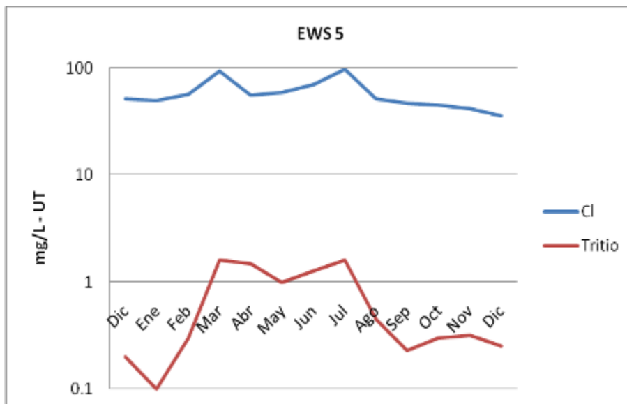
Fig. 4. Ejemplo de patrón de Cloruros y Tritio en un acuífero de aguas dulces.
